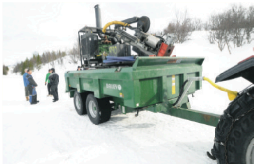
Riggen er en av de minste selskapet bruker, og veier snauet to tonn.
